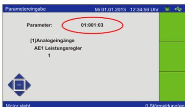
Zum Bearbeiten der Parameter muss das Menü Parametereingabe unter dem Punkt Einstellungen geöffnet werden. Editieren am KOP Mithilfe der Cursor-Tasten wird zunächst in der oberen Zeile des angezeigten Dialogs die Position des zu ändernden Wertes angewählt.
