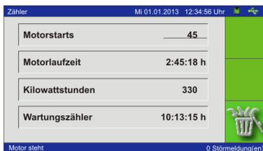
Im Bearbeitungsmodus können alle Zähler gleichzeitig zurückgesetzt werden.
