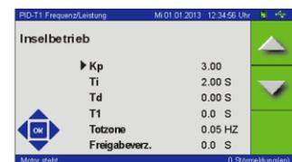
Die zwei zur Verfügung stehenden PID-T1 Regler müssen einem Analogausgang zugewiesen werden. Die Vorgabe für den Regelbereich ist nur über die Parametersoftware möglich.
