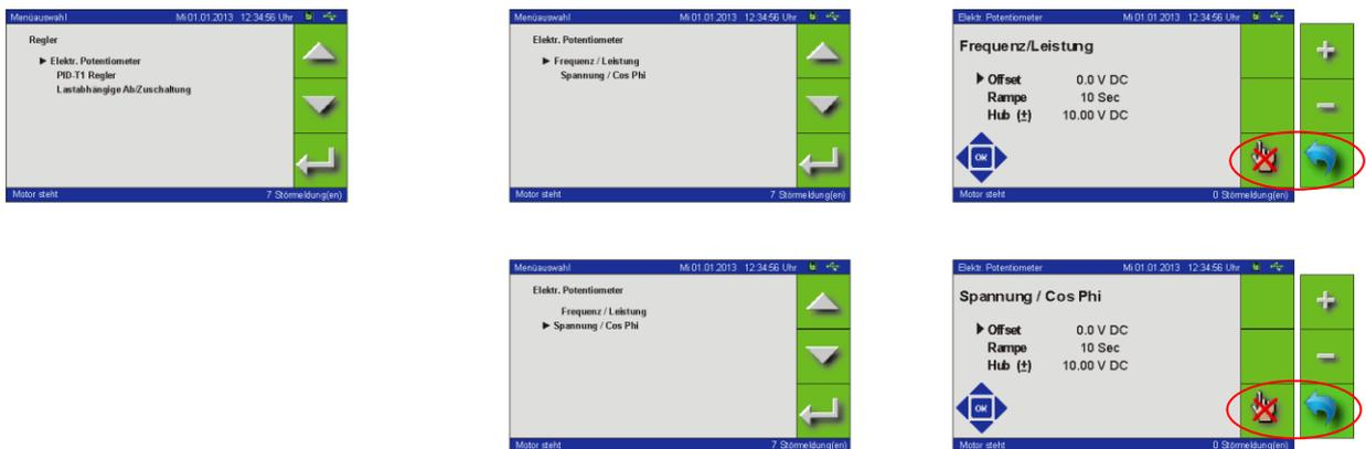
Es stehen zwei elektronische Potentiometer zur Verfügung. Die Potentiometer müssen einem Analogausgang zugewiesen werden um Einstellungen am Tableau vornehmen zu können. Die internen Signale des Impulsreglers wirken auf die Verstellung der Elektr. Potentiometer. Die Vorgabe für den Regelbereich des elektronischen Potentiometers erfolgt ausschließlich am KOP 2. Die Werte können jedoch mithilfe der Parametrier - Software Geräteverwaltung 2 ausgelesen und angezeigt werden.
