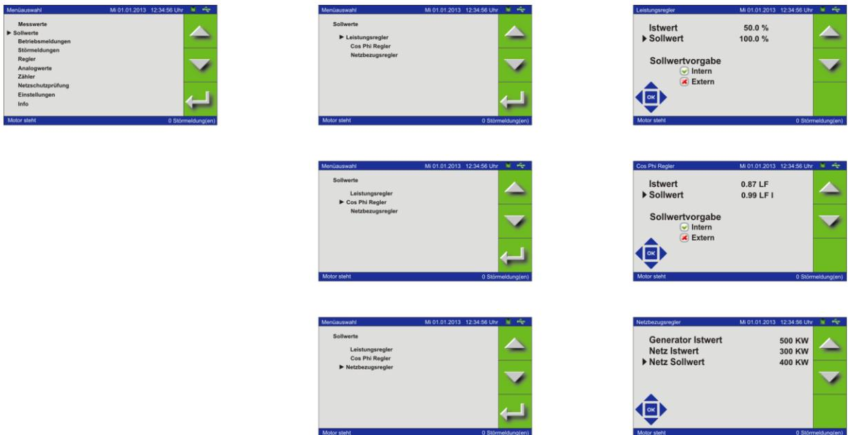
Es können für drei verschiedene Regler die Sollwerte vorgegeben werden. Für den Leistungsregler und für den Cos Phi Regler kann zusätzlich vorgewählt werden ob auf den eingestellten Sollwert am Tableau (Intern) oder auf den Analogwert (Extern) geregelt werden soll. Bei nicht über die Parametrierung aktivierten Reglern sind die Menütexthe graue hinterlegt und können nicht angewählt werden.
