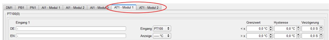
Es stehen zwei Messmodule mit jeweils 6 PT100(0) Messeingängen und 2 Analogeingänge zur Verfügung. Die Beschreibung erfolgt exemplarisch am Eingang 1 auf dem Modul 1.
