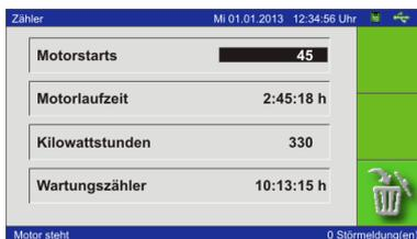
Sollen nicht alle Zähler zurückgesetzt werden so können über die Pfeiltasten einzelne Zähler angewählt werden. Der angewählte Zähler kann gezielt auf einen Wert gesetzt werden oder zurückgesetzt werden.
